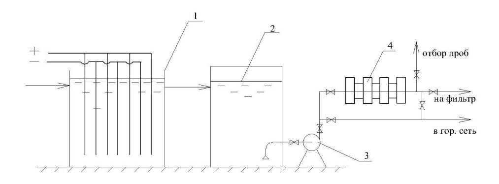
Рисунок 1 Схема подключения постоянных магнитных устройств CO-2 и CO-3 после производственных электрокоагуляторов 1 – производственный электрокоагулятор; 2 – сборная камера (отстойник); 3 – насосная установка; 4 – постоянные магниты
