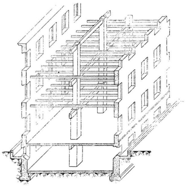
Рис 2. Трехэтажное здание с прямоугольными прогонами и с перекрытиями по деревянным балкам
