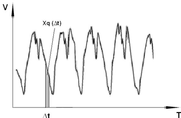
Рис. 1. Дискретизация трафика
