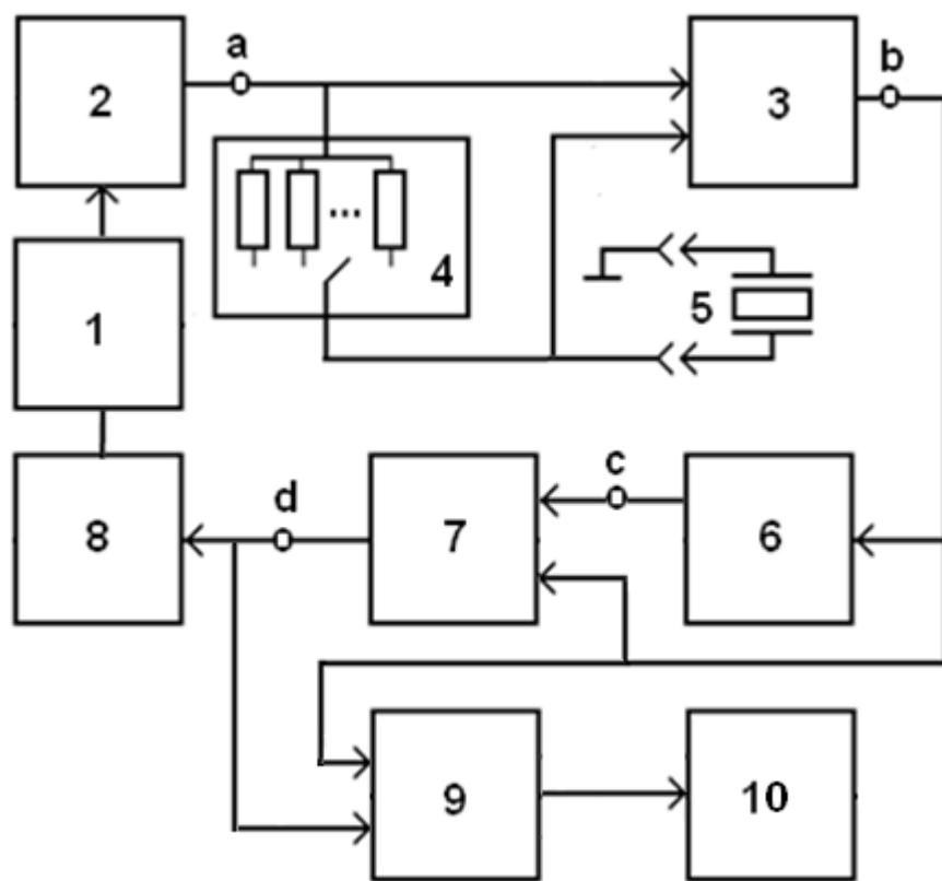
Рис. 3. Структурная схема прибора для контроля добротности и величины пьезомодуля материала ПКЭ
