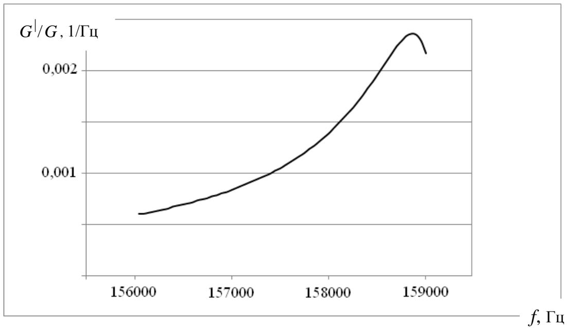
Рис. 2. Зависимость от частоты отношения производной к активной составляющей проводимости
