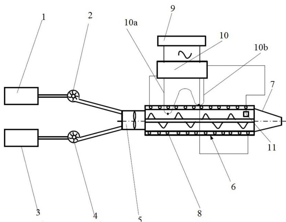
**Рис. 1. Схема лабораторной установки для получения и напыления гибридных неизоционатных изоляционных пен:** 1 – контейнер для компонента А; 2 – загрузочное дозирующее устройство для компонента А; 3 – контейнер для компонента В; 4 – загрузочное дозирующее устройство для компонента В; 5 – смеситель; 6 – промежуточная камера; 7 – выпускное сопло; 8 – нагреватель; 9 – источник питания; 10 – блок регулирования температуры; 10а–10б – дифференциальная термопара; 11 – датчик температуры.
