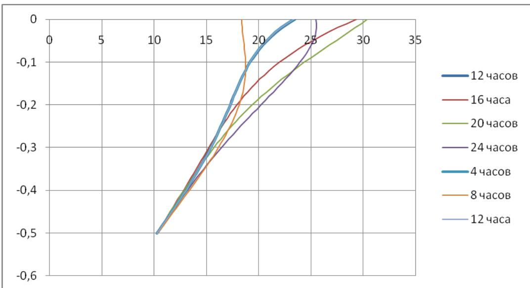
Рис. – Изменение температур в течение суток в грунте с учетом глубины.
