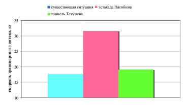
Рис. 1. - Средняя скорость движения при различных вариантах организации дорожного движения
