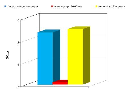
Рис. 3. - Массовый выброс  $NO_x$  в зависимости от принятых проектных решений
