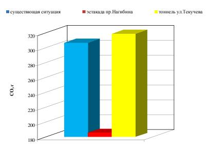
Рис. 2. - Массовый выброс СО в зависимости от принятых проектных решений
