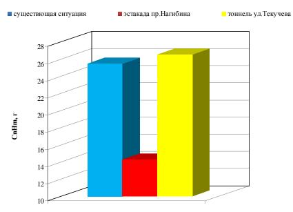
Рис. 4. - Массовый выброс  $C_n H_m$  в зависимости от принятых проектных решений
