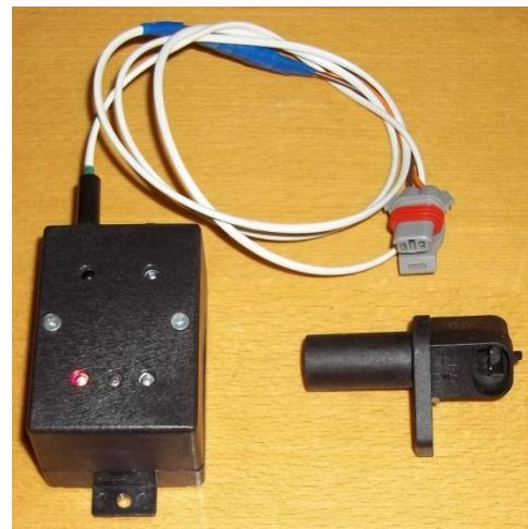
Рис. 2. – Указатель с преобразователем и датчик (слева)
