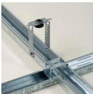
Рис. 2. Вариант 2. Двухуровневая система с металлическим каркасом для крепления подвесного потолка на гибких стальных подвесах с расстоянием между подвесным потолком и плитой до 200 мм. Рисунок взят с сайта: [utepliteli-77.ru/products/podves-priamoj-knauf-knauf](http://utepliteli-77.ru/products/podves-priamoj-knauf-knauf)
