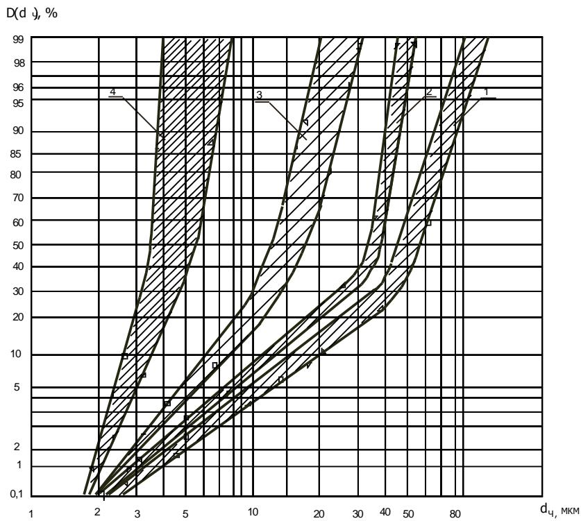
Рис. 1 - Диапазон изменения интегральных функций распределения массы частиц пыли по диаметрам: 1- в системе аспирации до очистки в циклоне; 2 - в системе аспирации после очистки в циклоне; 3 - в системе вытяжной общеобменной вентиляции; 4 - в санитарно-защитной зоне
