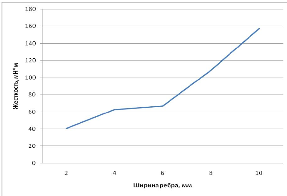
Рис.4 - Зависимость влияния ширины полимерного ребра (толщина полимерного ребра 70 мкм) на жесткость локально модифицированной ткани Премьер-комфорт-250 .
