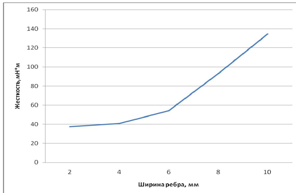
Рис.3 - Зависимость влияния ширины полимерного ребра (толщина полимерного ребра 50 мкм) на жесткость локально модифицированной ткани Премьер-комфорт-250 .
