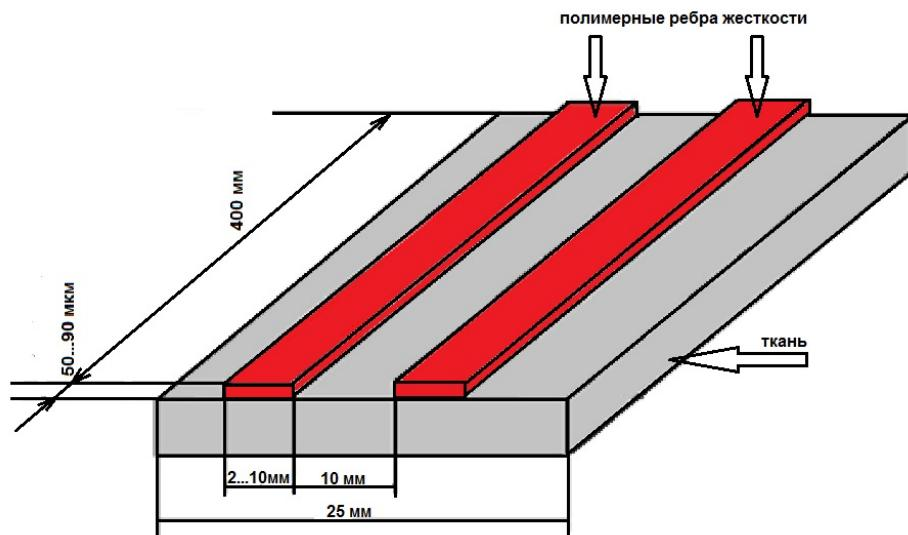
Рис. 1. – Схема формирования усиливательных полиэтиленовых каналом (ребер жесткости) на внутренней поверхности ткани
