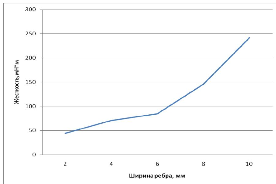
Рис.5 - Зависимость влияния ширины полимерного ребра (толщина полимерного ребра 90 мкм) на жесткость локально модифицированной ткани Премьер-комфорт-250 .
