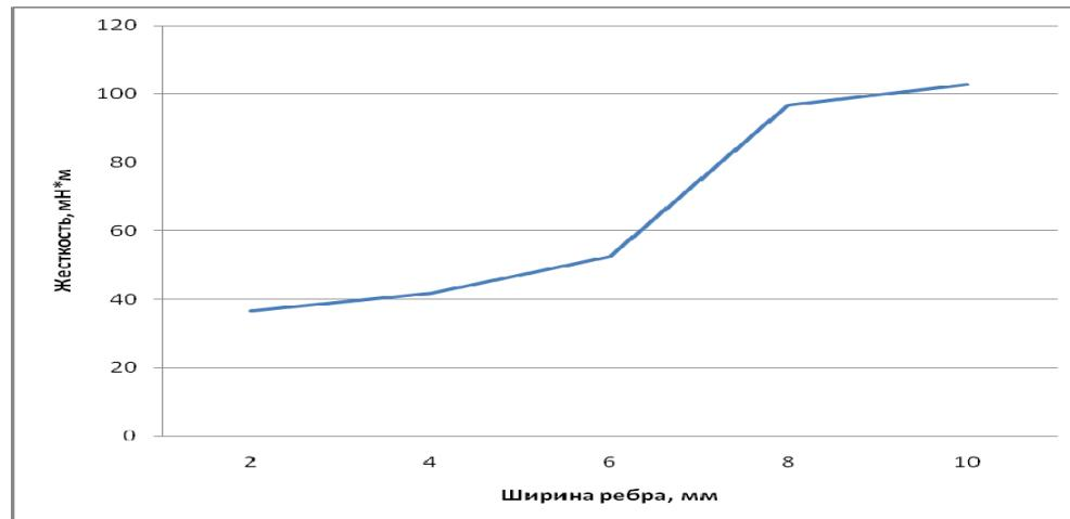
Рис.2 - Зависимость влияния ширины полимерного ребра (толщина полимерного ребра 40 мкм) на жесткость локально модифицированной ткани Премьер-комфорт-250 .
