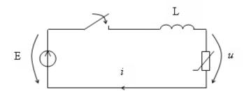
Рис. 1. – Схема замещения нелинейной электрической цепи первого порядка
