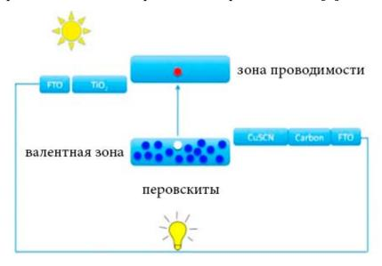
Рис. 3.- Принцип работы перовскитных фотоэлементов
