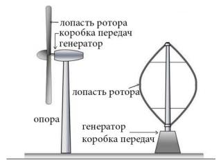
Рис. 5.-Отличительная схема турбин HAWTs и VAWTs
