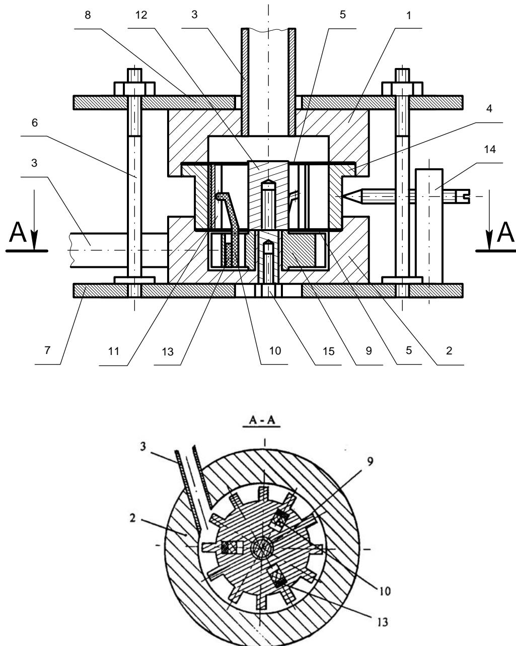
Рис. 1 – Устройство для гальваномеханического нанесения покрытий
