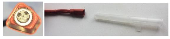
Рис. 3. – Конструкция разработанного авторами мундштука: а) сенсор; б) мундштук
