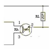
Рис. 1. – Схема сенсора MQ303B
