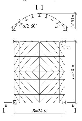
Рис. 1 – Схема цилиндрической сетчатой оболочки
