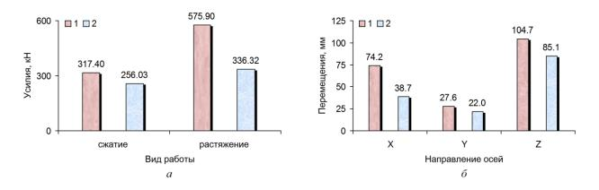
Рис. 2 – Максимальные усилия в элементах (a) и максимальные перемещения узлов (б) оболочки: 1 – исходной; 2 – подкрепленной
