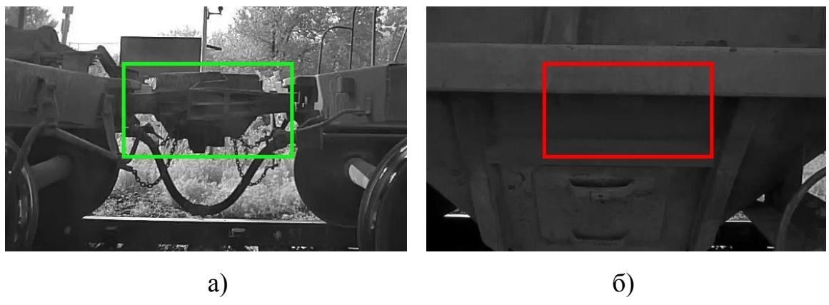
Рис. 2. – Примеры кадров с выделенной заданной областью интереса: а) автосцепка находится в заданной области интереса, б) автосцепка в заданной области отсутствует
