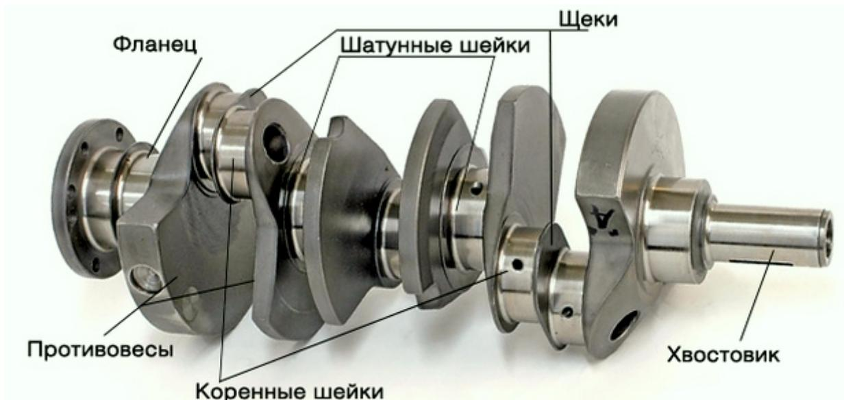
Рис. 1. - Коленчатый вал двигателя внутреннего сгорания
