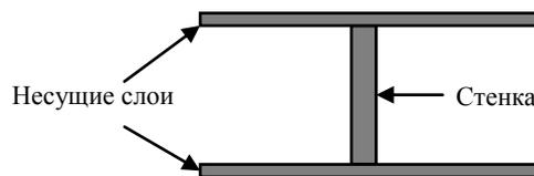
Рис. 1. – Элемент многостеночной пластины
