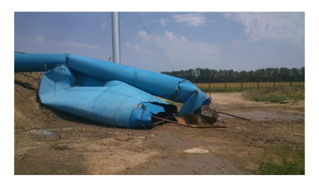
Рис.6. Обрушение башни Рожновского вследствие потери местной устойчивости стенки
