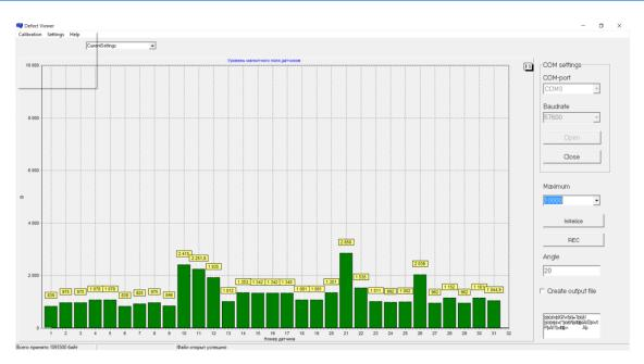
Рис. 7. – Рабочий экран диагностического ПО. Визуализация фиксируемого датчиками магнитного поля с дефектами
