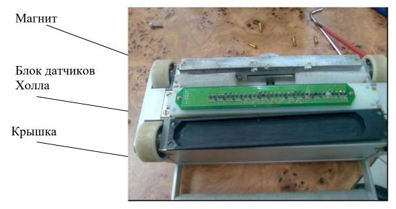
Рис. 4. – Рабочая часть модели А.020.00.00.00
