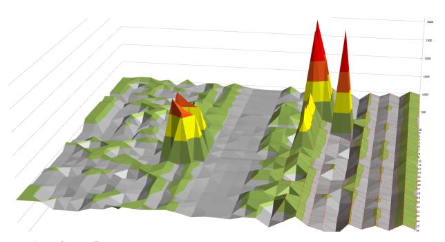
Рис. 8. – Объемная развертка результатов магнитного сканирования
