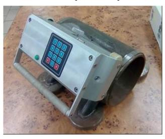
Рис. 5. – Пример самофиксации прибора на теле трубы из ферромагнитного материала
