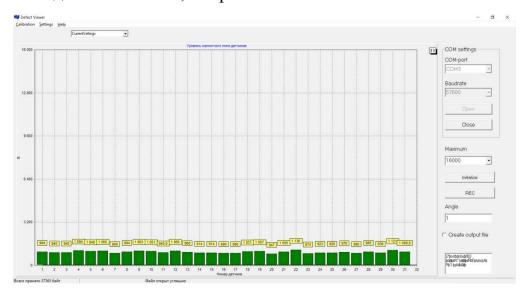
Рис. 6. – Рабочий экран диагностического ПО. Визуализация фиксируемого датчиками магнитного поля без дефектов
