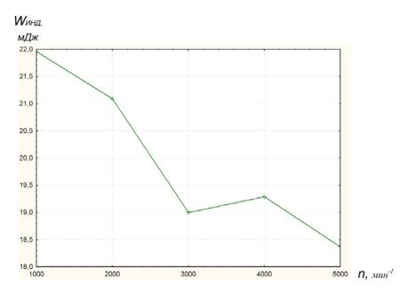
Рис. 2 — Энергия  $W_{\rm MP}$ , выделяемая в межэлектродном зазоре свечи зажигания индуктивной фазой ТрСЗ на холостом ходу в зависимости от частоты вращения n коленчатого вала двигателя
