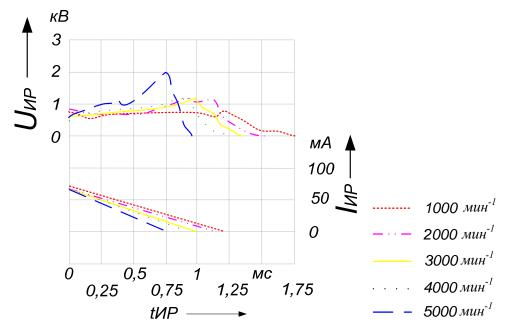
Рис. 1 — Амплитудно-временные параметры индуктивных фаз искрового разряда, формируемого ТрСЗ на холостом ходу в зависимости от частоты вращения n коленчатого вала двигателя
