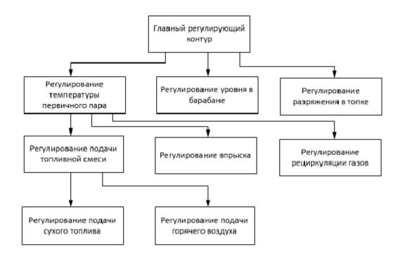
Рис. 1. Структуры управления энергетическими котлоагрегатами большой мощности
