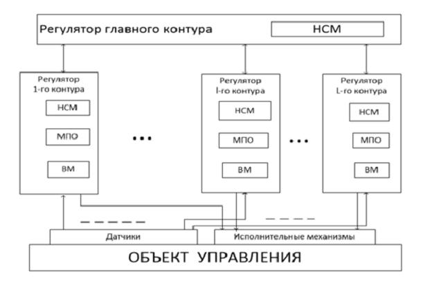
Рис. 2 Схема интеллектной автоматизированной системы (ИАС)
