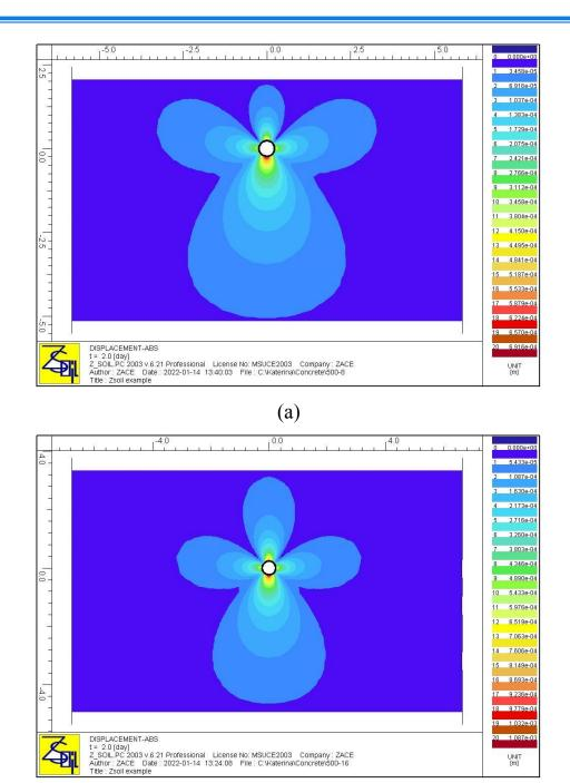
Рис. 4. – Перемещения в массиве при эксперименте с футляром 500 мм: (а) – глубина 8 м; (б) – глубина 16 м.
