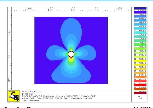
Рис. 3. – Перемещения в массиве при эксперименте № VIII
