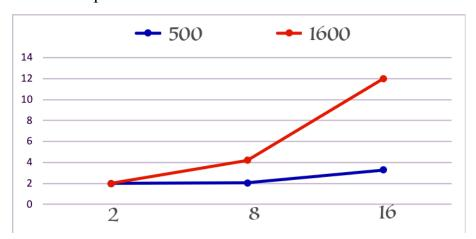
Рис. 6. – Перемещения в массиве при эксперименте с футлярами с внутренним диаметром 500 мм и 1600 мм
