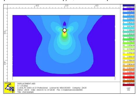
Рис. 2. – Перемещения в массиве при эксперименте № І
