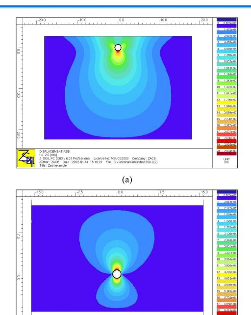
Рис. 5. – Перемещения в массиве при эксперименте с футляром 1600 мм:  $(a) - глубина \ 2 \ м; \ (б) - глубина \ 16 \ м.$
