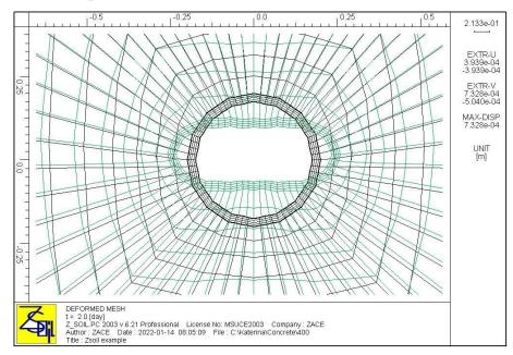
Рис. 1. – Результаты расчета железобетонного футляра по деформациям
