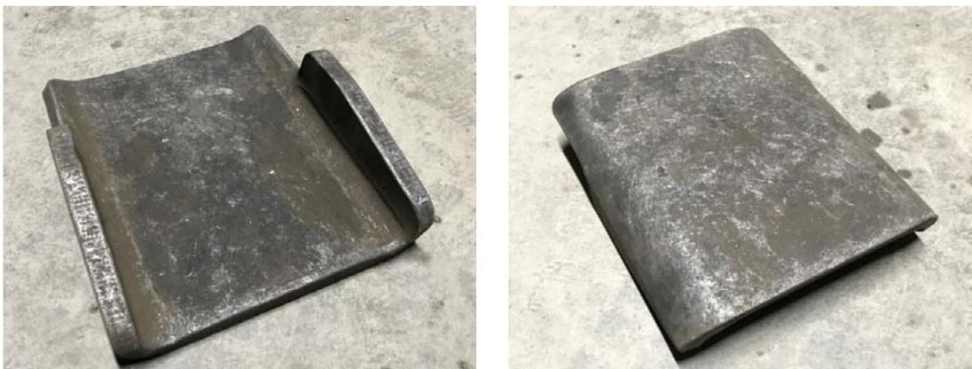
Рис. 5 – Подвижная пластина поглощающего аппарата АПФК-110 из сортового проката 30ХГСА
