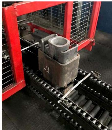
Рисунок 6 – Сборка и испытание поглощающего аппарата АПФК-110
