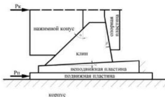
Рис. 3. - Принципиальная схема клиновой системы на этапе нагружения
