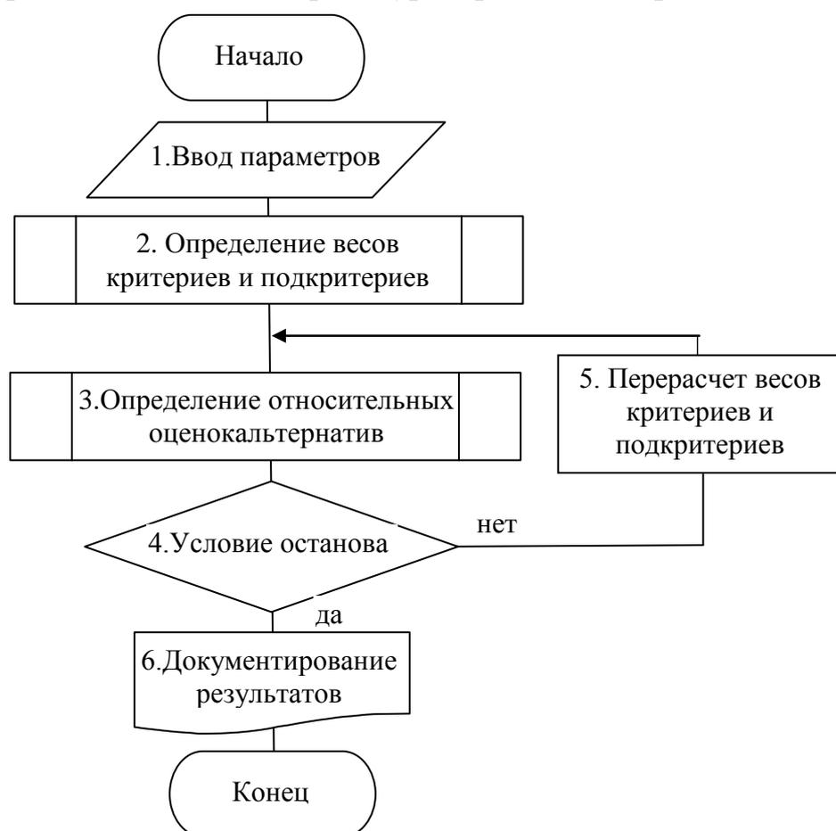
Рис. 2. Блок-схема процедуры выбора альтернативы на основе ММАС
