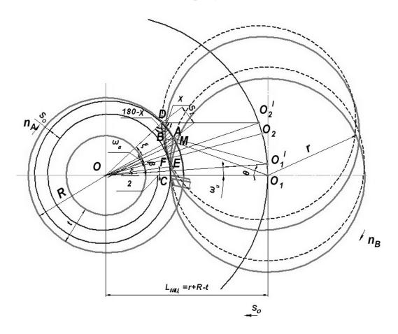
Рис. 1. Схема фрезерования дисковой фрезой с круговой и радиальной подачей
