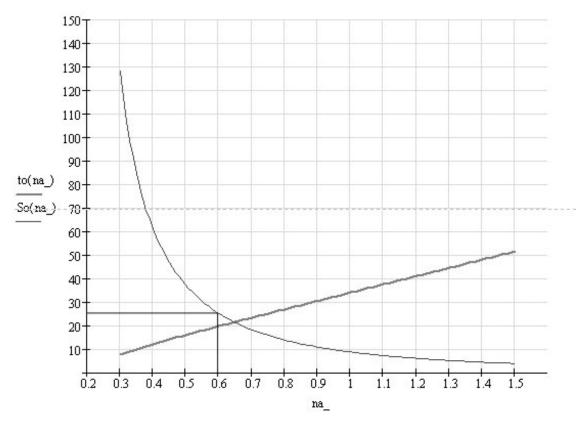
Рис. 2. График зависимости радиальной подачи и основного технологического времени от частоты вращения детали
