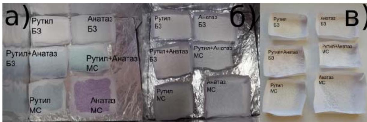
Рис. 1 - Изменение цвета образцов до облучения светом (а) и после облучения в “solar box” в течение 3 ч. (б) и 6 ч. (в)
