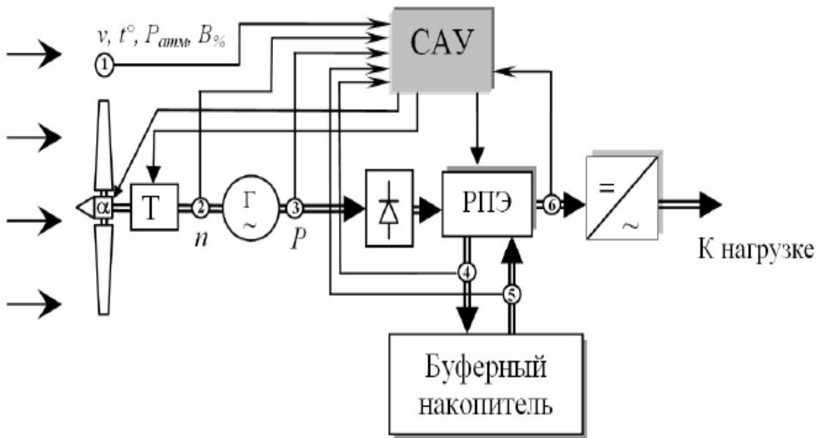
1 – контроль скорости ветра, температуры окружающей среды, атмосферного давления, относительной влажности; 2 – контроль частоты вращения ветроприёмника; 3 – контроль генерируемой электрической мощности; 4, 5 – контроль потоков мощности на буферном накопителе; 6 – контроль потребляемой электрической мощности;  $\alpha$  – управление шагом лопасти; Т – трансмиссия (мультипликатор + тормоз); Г – генератор переменного тока
