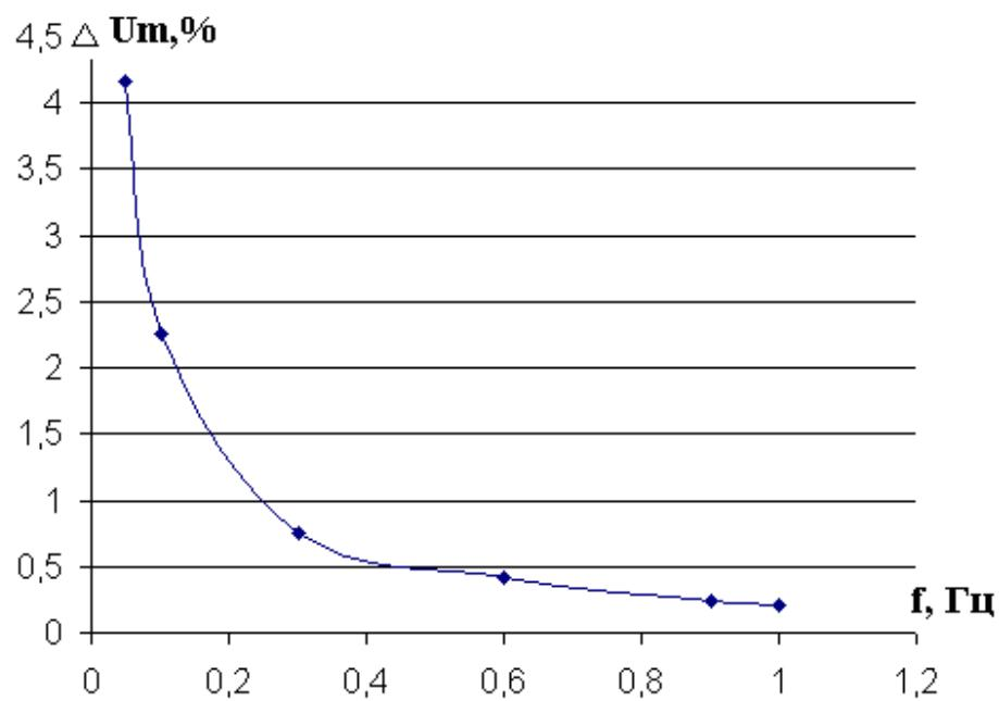
Рис. 2– Частотная характеристика напряжения с выхода выпрямителя
