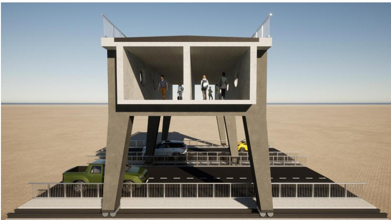
Рис. 3. – Конструкция мобильного технологического элемента эстакад по фронту их действия [10].
