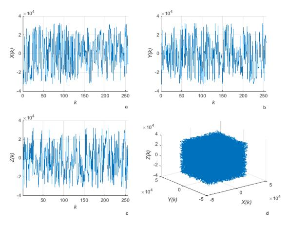
Рис.1. Временная реализация псевдослучайного сигнала построенного на базе системы Лоренца (a, b, c) и фазовый портрет (d)
