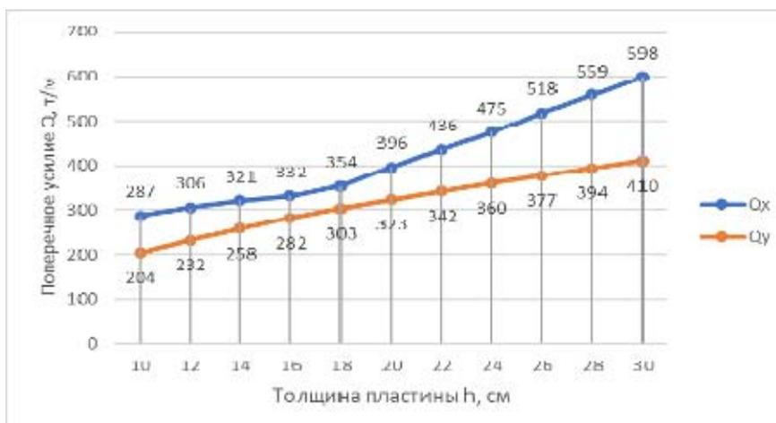
Рис. 5. – График зависимости усилий  $Q_x$ ,  $Q_y$  от толщины оболочки  $h$
