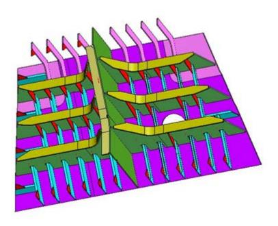
Рис. 4. - Рамный набор наклонного борта опорного блока МНС
