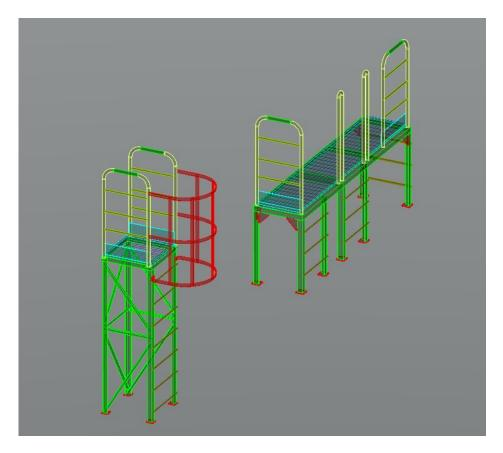
Рис. 2. - 3D модель площадки обслуживания
