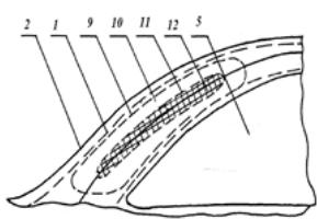
Рис. 2. — Схема элемента капсулы живучести с ампулизированным нагревателем химического типа
