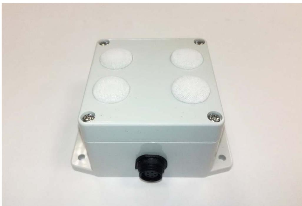
Рис. 2. — Внешний вид цифрового газового модуля с 4 датчиками
