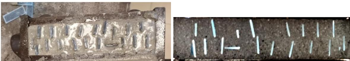
Рис. 1. – Образец с установленными прозрачными элементами до и после шлифовки
