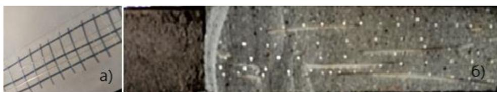
а) леска с приклеенными оптоволоконными, б) образец после шлифовки
