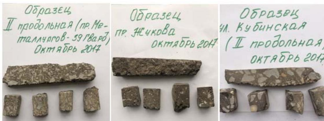
Рис. 1. – Исследуемые образцы асфальтобетонных покрытий
