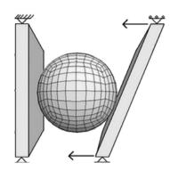
Рис. 2 Горная порода сферической формы, помещенная в камеру щековой дробилки
