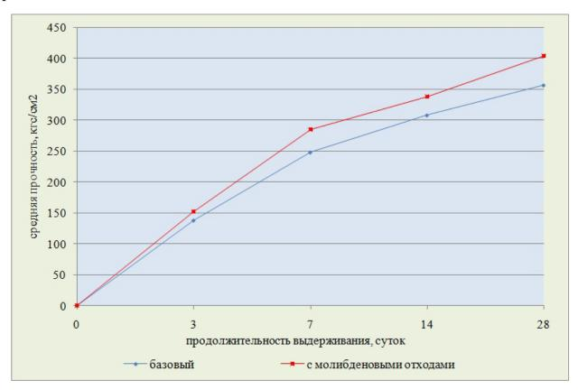
Рис.1. - Диаграмма результатов испытаний образцов на прочность
