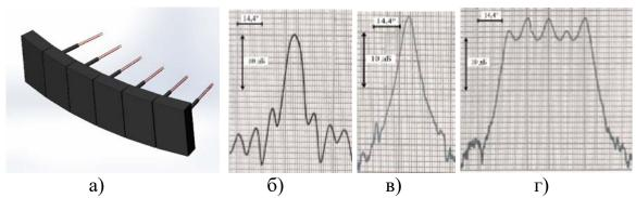
Рис.4. – Антенна накачки гидролокатора траверзного обзора а) внешний вид антенны; б) ДН 1 модуля на частоте накачки 250 кГц; в) ДН 1 модуля на разностной частоте 30 кГц; г) ДН антенны из 6 модулей на разностной частоте 30 кГц;
