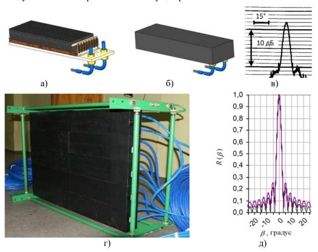
Рис.3. – Антенна накачки параметрического сейсмопрофилографа а) - 3D-модель без герметизирующего компаунда; б) - 3D-модель с герметизирующем компаундом; в) – ДН на разностной частоте 3 кГц; г) – антенна накачки с несущей рамой; д) – ДН антенны на частоте
