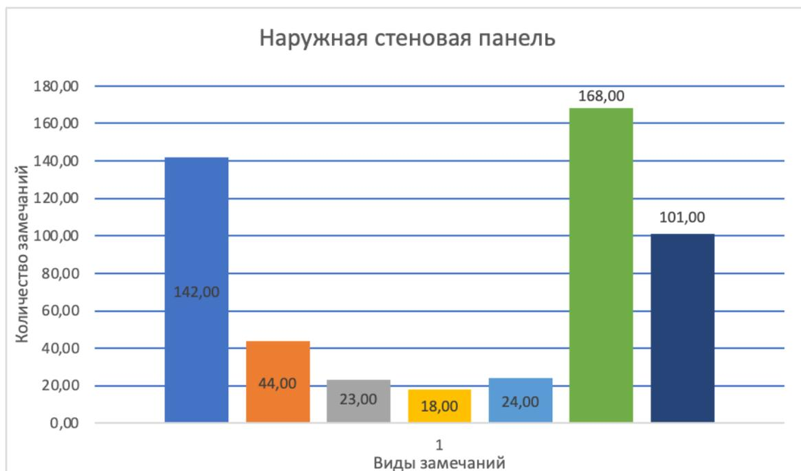
Рис. 3. - Гистограмма ошибок монтажа наружной стеновой панели
