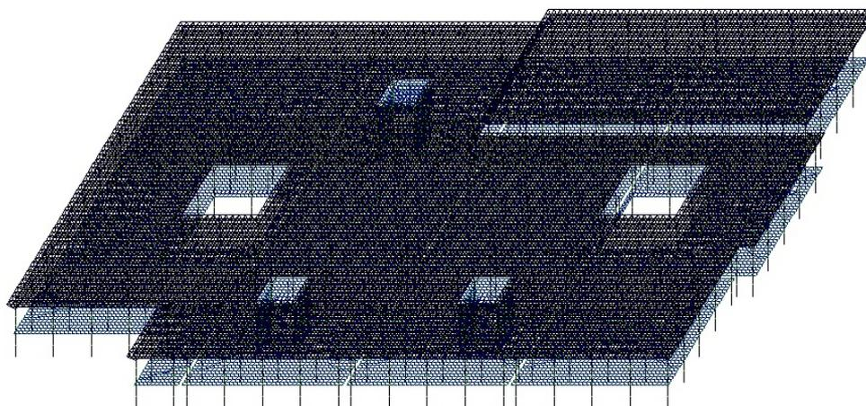
Рис. 6. Расчётная схема здания с покрытием.
