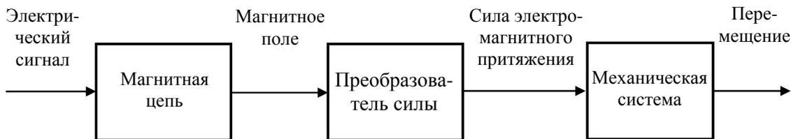
Рис. 2. – Обобщенная структурная схема процесса работы электромагнита.
