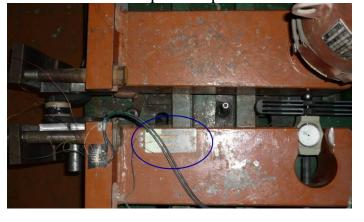
Монтаж балансировочных тензорезисторов Рис. 1. – Установка тензорезисторов
