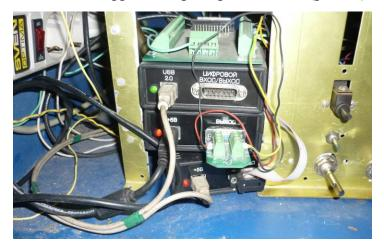
Рис. 3. — Двухканальный усилитель и аналого-цифровой преобразователь На втором этапе проходят стендовые испытания коленчатых валов при выбранных циклах нагружения. При достижении предельного состояния исследуемого вала (при усталостных испытаниях для определения предела выносливости - излом) с целью установления точного количества циклов нагружения срабатывает устройство автоматического отключения питания резонансного стенда.
