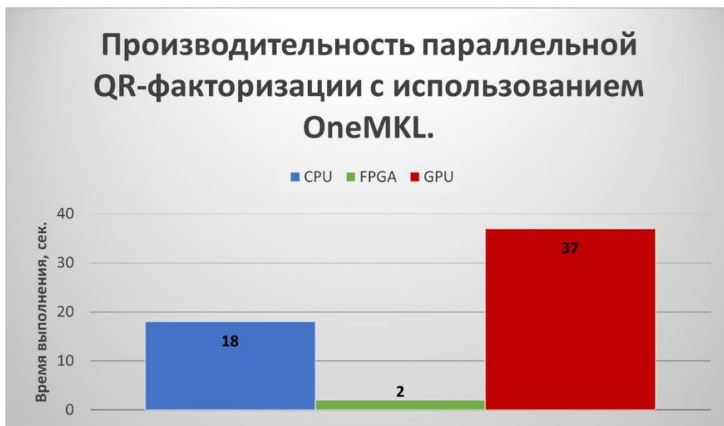
Рис. 4. - Результат QR-факторизации матрицы, размерностью 10000x10000 элементов
