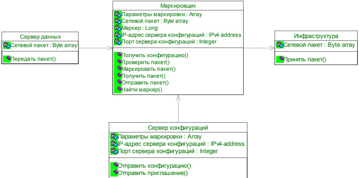
Рис. 3. – Диаграмма классов объектов Маркировщика *EtherMark*
