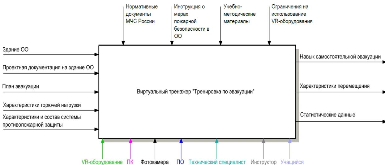
Рис. 1. – Контекстная диаграмма виртуального тренажера для формирования готовности учащихся к самостоятельной эвакуации
