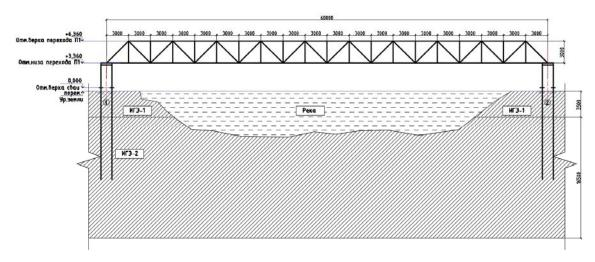
Рис.2 - Инженерно-геологический разрез
