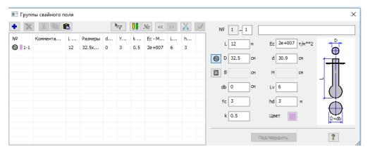
Рис.5 - Задание параметров для расчета жесткостей свай
