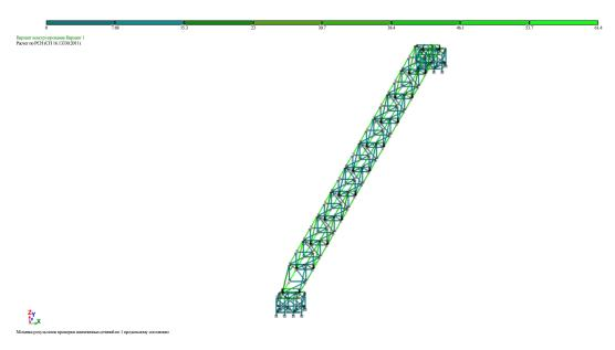
Рис.6 - Проверка сечений по первой группе предельных состояний (при моделировании свайного фундамента и грунтового основания)
