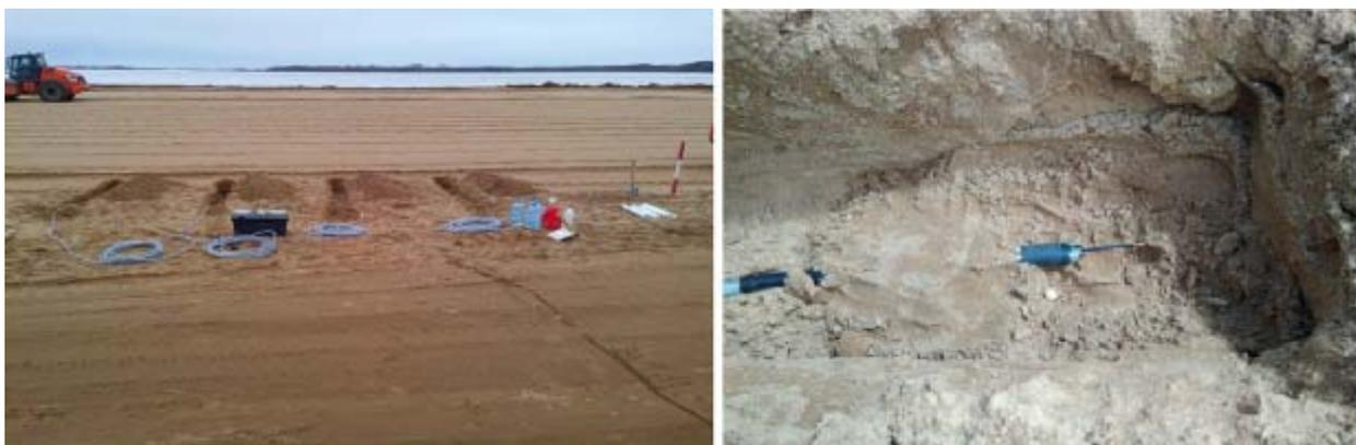
Рис. 4. – Тарировка датчиков влажности
