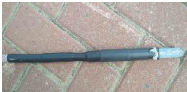
Рис. 1. – Защитная конструкция датчика влажности
