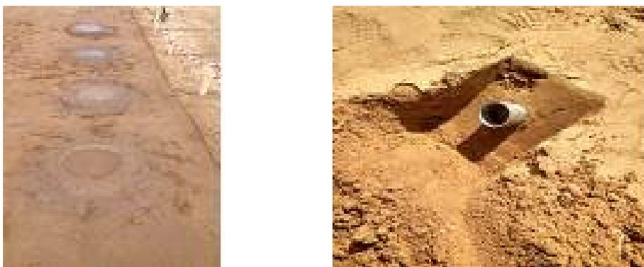
Рис. 5. – Увлажнение мест закладки датчика и отбор проб грунта для определения его влажности и плотности
