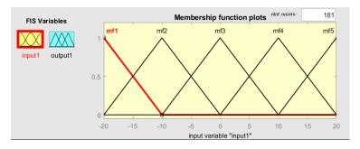
Рис. 8. - Функции принадлежности для входного сигнала: разница длины очереди.
